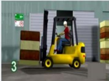
3 Incline el mástil hacia atrás y levante las horquillas
