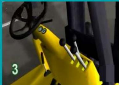
3 Coloque palanca de avance en neutral
