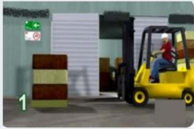
1 Acérquese a la carga, ajuste las horquilla del pallets
