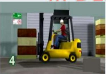
4 Coloque el mástil perpendicular al piso
