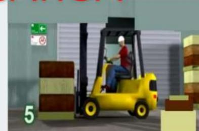
5 Baje las horquillas hasta que la carga descanse
