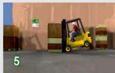
No levante una carga que supere la capacidad de la máquina
